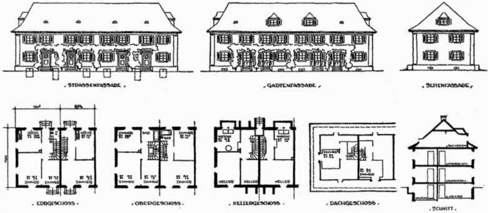
Fassaden, Grundrisse und Schnitt des ursprünglichen Reihenhauses
